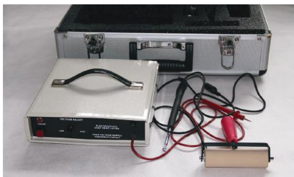
تصویر ۱۱- دستگاه بلند کردن گرد و غبار الکترواستاتیک می تواند برای دریافت شواهد احتمالی مانند ردپاها و مسیرهای تایر استفاده شود (© Richard C. Li.) .
