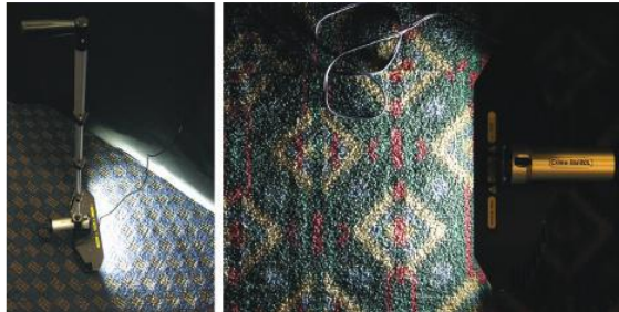
تصویر ۱۳- دستگاه دیود (LED) با شدت بالا برای قرار دادن مدارک در صحنه جرم ، به ویژه در برجسته سازی شواهد مانند موها، الیاف و چاپ کفش موثر است (© Richard C. Li).
